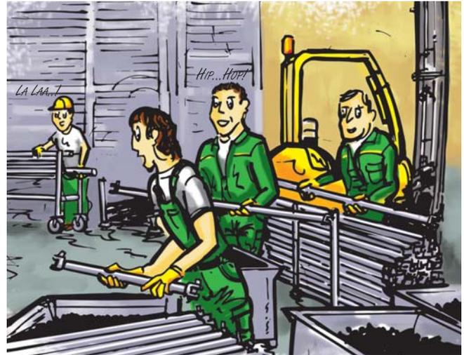
Les magasiniers vérifient une par une toutes les pièces. Une fiche de contrôle détaillée les aide à trier celles qui sont à nettoyer de celles qui sont à réparer et de celles qui sont à rebuter.
